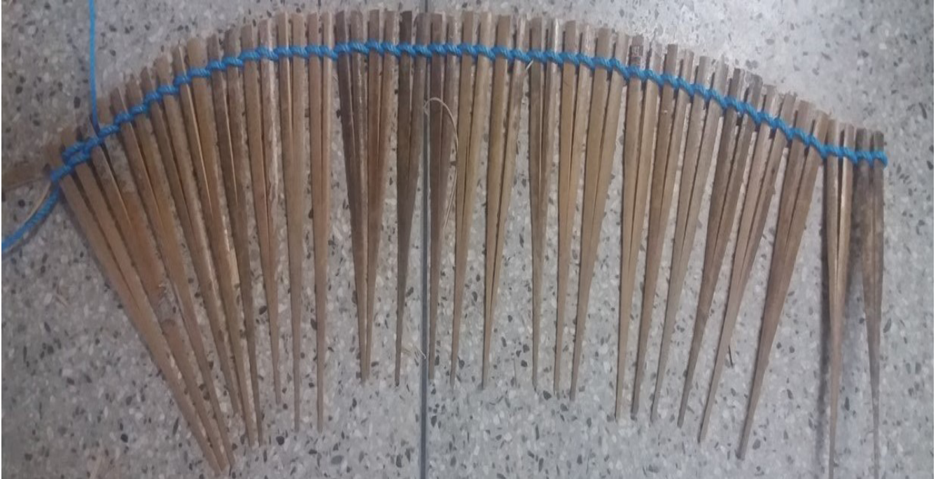
Figura 12 - Construção da língua com náilon de 4mm
