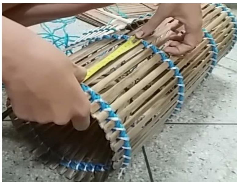
Figura 8 - Medida para cada uma das quatro divisões do pari-tapete
