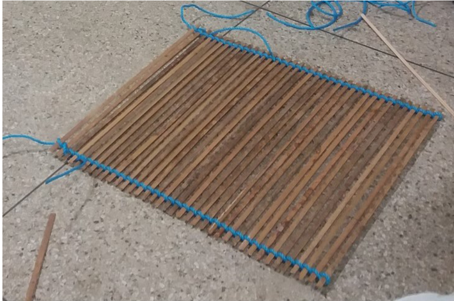
Figura 7 - Tecimento nas extremidades do tapete
